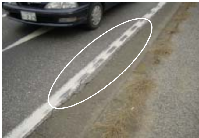
写真 - 1 ABS 装備車によるスキッドマーク
