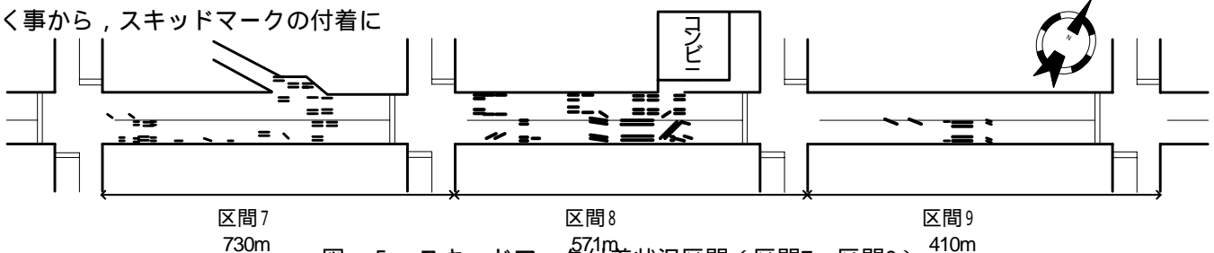
図 - 5 スキッドマーク付着状況区間 (区間7～区間9)
