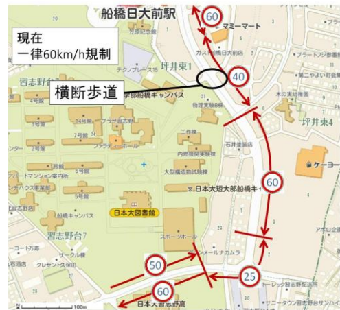
図-7 マミー道路のドライバーに有益な規制速度イル値を用いているが、本研究で提案した設定方法は、線形や横断面の構成要素を用いて規制速度を設定している。これにより、線形が厳しい道路などによって、明確に安全な速度を設定することが可能になる。実際の運用では、規制速度を設定した後、車両の実勢速度によって規制速度を見直すことが重要である。
